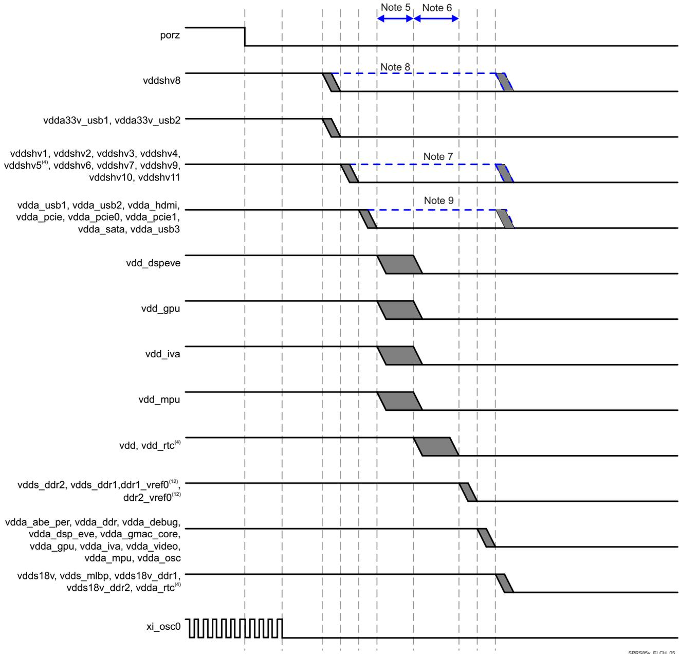
**Figure 5-3. Power-Down Sequencing<sup>(10)(11)</sup>**
